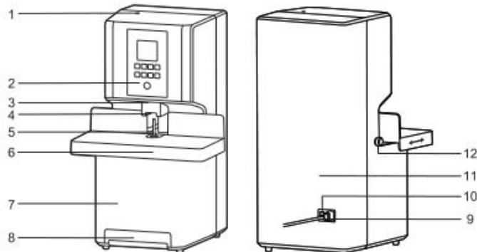
1.铝管(入料口) 2.操作面板 3.防护罩 4.导电橡胶垫 5.钻刀 6.工作台面 7.前壳
