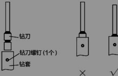
安装钻刀：将钻刀装入钻套的钻刀口，将钻刀装至底部后，使用内六角扳手锁紧钻刀螺钉后，按[复位]键即可
